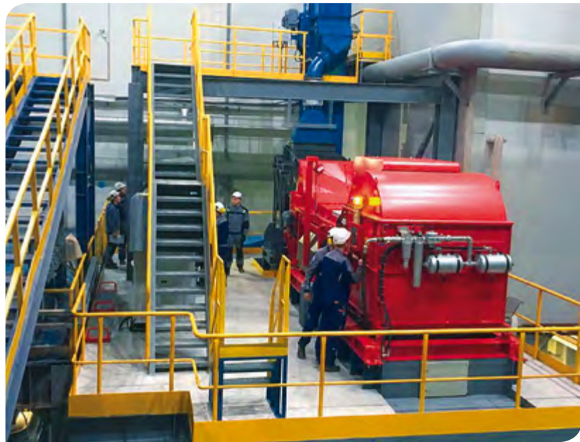
Сепаратор COM Tertiary XRT на обогатительной фабрике ГОКа им. В. Гриба.
