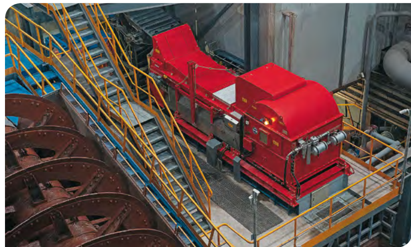
Размещение XRT-сепаратора на обогатительной фабрике ГОКа им. В. Гриба
